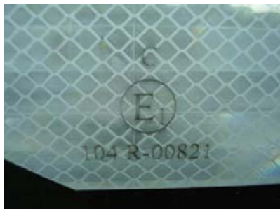
Obr. 2.: Schvaľovacia značka podľa predpisu EHK č. 104 na reflexnom páse bielej farby. Znak „C“ v hornej časti určuje, že ide o pás na vyznačenie obrysov vozidla. Materiál na nepovinné plošné nápisy a grafiku má označenie „D“ (pre použitie na obmedzených plochách) alebo „E“ (pre použitie na veľkých plochách).
