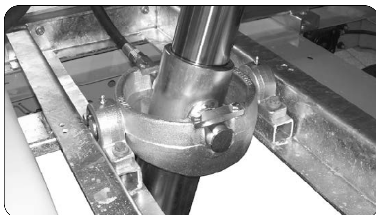
Uchycení zvedacího pístu Mounting the lifting piston
