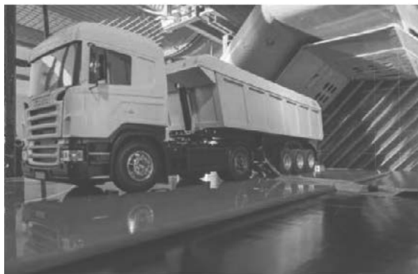
Testování střechy ve větrném tunelu (institut IFI Aachen). / Tests in the wind tunnel at IFI Institute Aachen.
