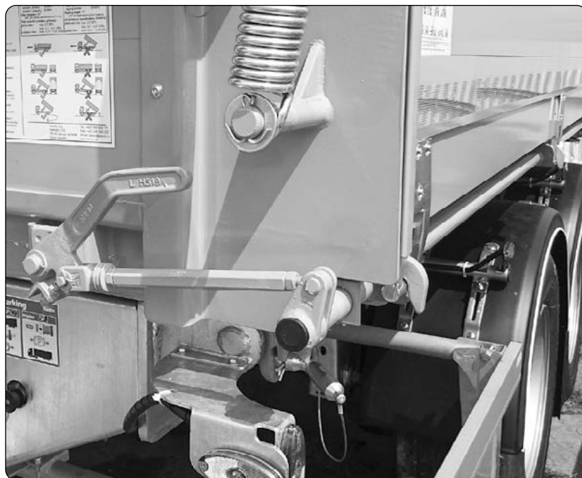
Centrální závěr bočnice H 519 / Side central lock H 519
