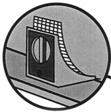
Nastavitelný zaistovacia klin (pozdĺžny) s protišmykovým pásikom
