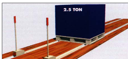
Jazdce sú vložené v zahĺbených vedeniach a posúvané pod náklad
