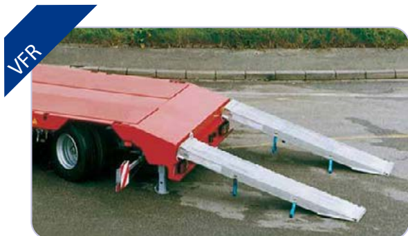
Zatížení - 32 000 kg/pár Hmotnost 104 kg
