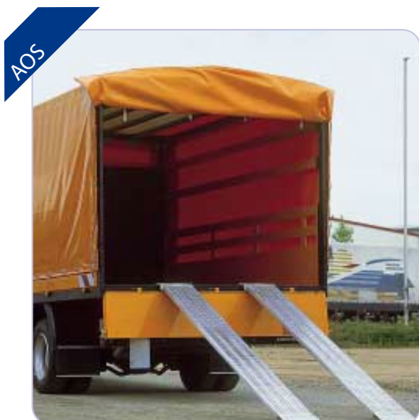
Zatížení - 32 000 kg/pár Hmotnost 104 kg
