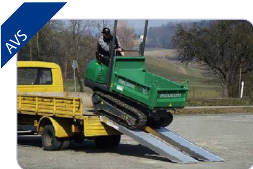
Zatížení - 4 390 kg/pár Hmotnost 31 kg
