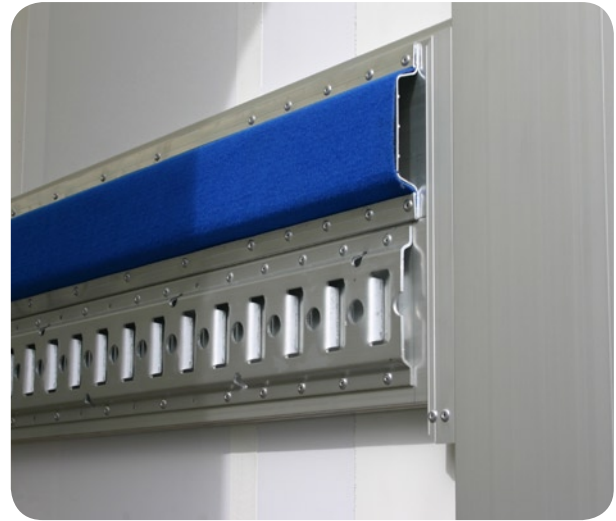
Obr. 3 Detail upevnění dvojitého plachtového prkna
