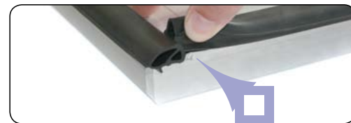
Zajištění těsnění / Sealing
