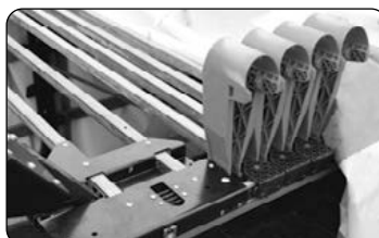
Ansicht Endlaufwagen und Gelenke Rear trolley and hinges
