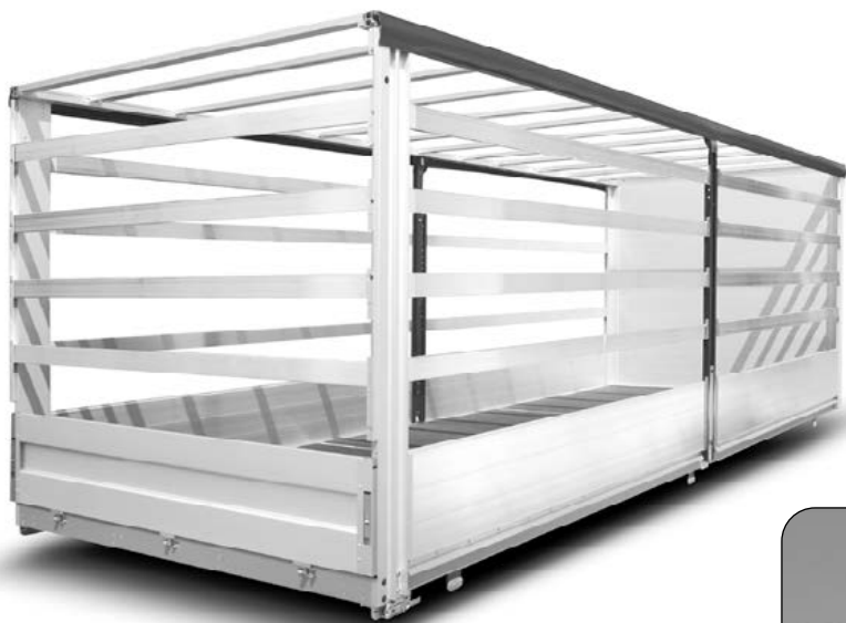
Aufbau CS MIDI mit einem Festdach und Aluminium-Seitenrungen CS MIDI kit with fixed roof and steel side pillars
