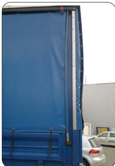
*Durchbiegung des Spannrohres*
