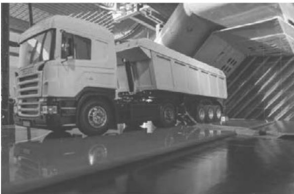
Testovanie strechy vo vzdušnom tunely IFI Achen. / Testowanie dachu w tunelu aerodynamicznym w IFI Institut Aachen.
