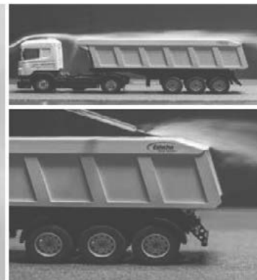
Testovanie strechy vo vzdušnom tunely IFI Achen. / Testowanie dachu w tunelu aerodynamicznym w IFI Institut Aachen.
