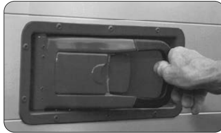
Nerezový zámok pre bočné i centrálné zamykanie bočnice
